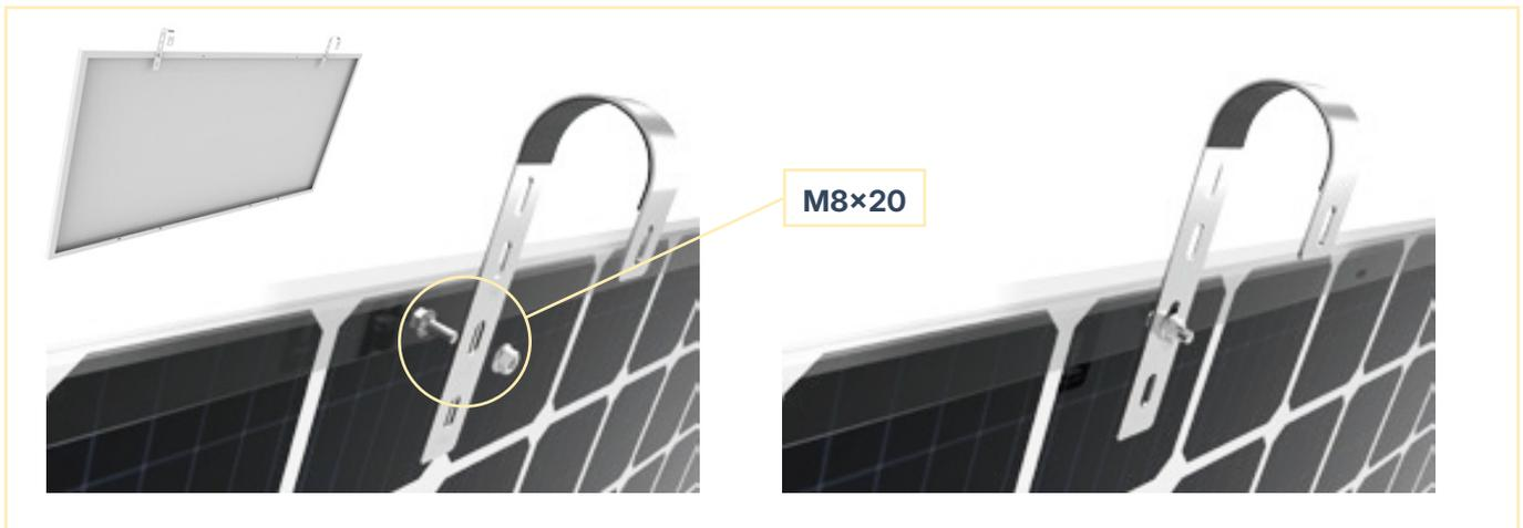
Befestige die beiden Haken am Solarmodul. Nutze hierfür je eines der vorgesehenen Löcher am Modulrahmen der jeweiligen Seite und je eine M8×20 Schraube sowie die entsprechende Mutter. Die Mutter befindet sich hierbei auf der Innenseite des Modulrahmens. Ziehe nun die Schrauben fest an.
