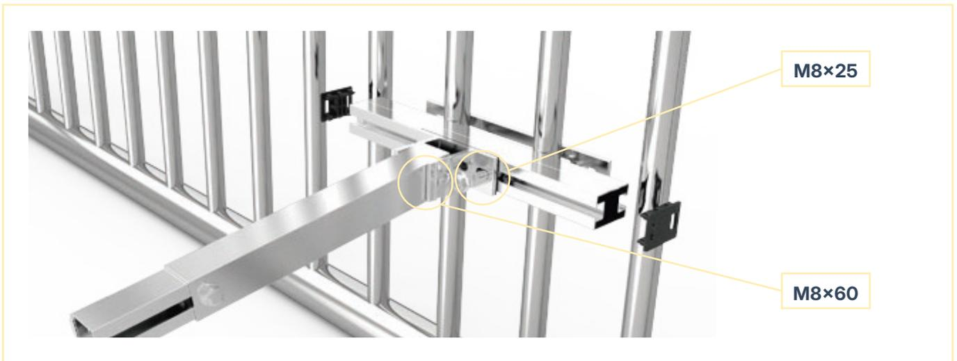
Die am Solarmodul befestigten Teleskopstangen werden nun mit der Führungsschiene verbunden. Hierfür werden die zwei Schrauben am unteren Ende jeder Teleskopstange gelöst, in die Führungsschiene eingeführt und wieder mit der Teleskopstange verschraubt (siehe Bild). Ziehe die Schrauben fest an.
