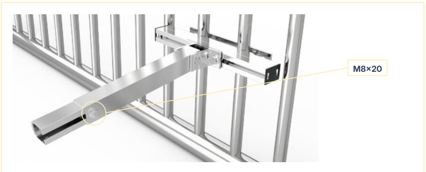
Falls notwendig, kann der Neigungswinkel des Moduls mithilfe der Schraube in der Mitte der Teleskopstangen nun justiert werden (siehe Bild). Ziehe die Schraube fest an, sobald Du mit dem Neigungswinkel des Moduls zufrieden bist. Der Winkel muss bei beiden Teleskopstangen identisch eingestellt werden.
