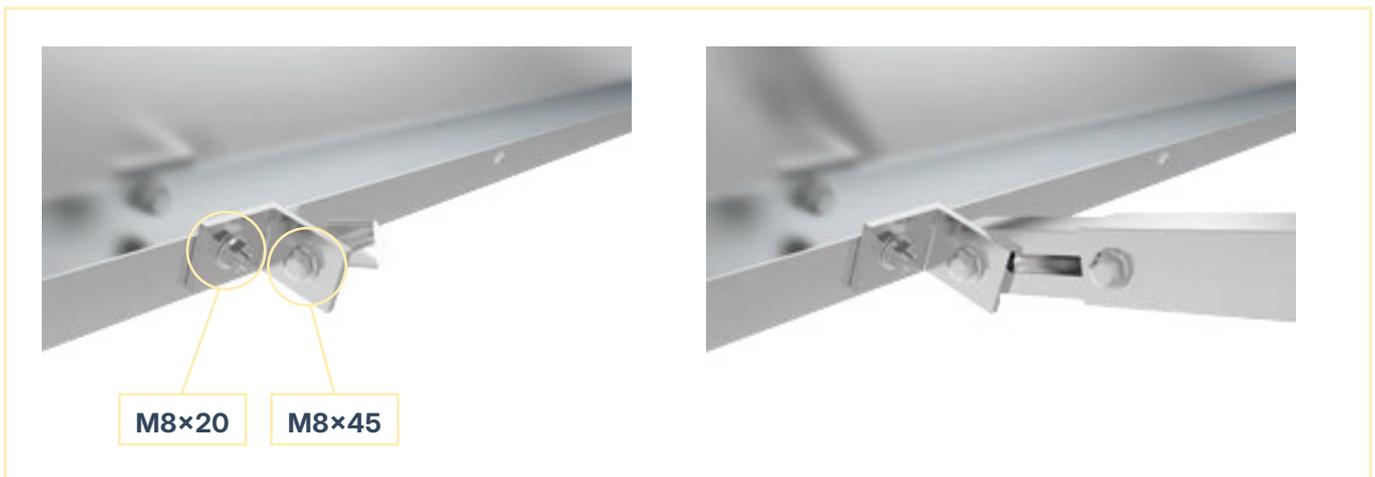
Befestige mithilfe der Schrauben die L-FüÙe auf der den Haken gegenüberliegenden Seite des Modulrahmens und verbinde diese anschließend mit der Teleskopstange. Verriegele und fixiere das Teleskopteil entsprechend dem für die Installation erforderlichen Winkel, bevor Du die Teleskopstange am Rahmen befestigst. Der Winkel kann später noch nachjustiert werden.
