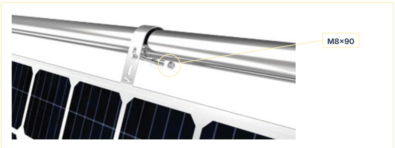
Die Haken werden an das Balkongeländer gehängt, die Schrauben M8x90 hindurchgeführt (siehe Bild) und mit je einer Mutter fixiert. Die Schraube wird nur handfest angezogen, um ein nachträgliches Arretieren des Moduls zu ermöglichen. Ziehe die Schraube fest an, sobald Du mit der Position des Moduls zufrieden bist.
