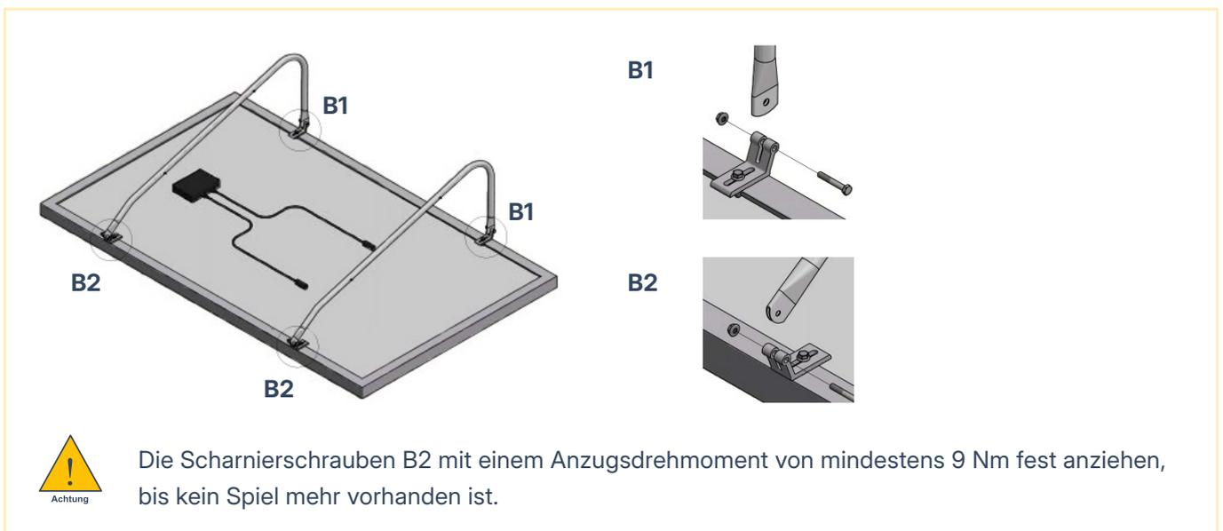
Je nach Modulbreite müssen die Klemmen B1 und B2 nach innen oder außen positioniert und mit Hilfe der langen M8 Schrauben und der entsprechenden Mutter mit den Aluminiumträgern verbunden werden. Die richtige Ausrichtung für die jeweilige Modulbreite findest Du unter 1.3 auf der nächsten Seite. Ziehe die Scharnierschrauben B1 nur handfest an. Diese müssen in Schritt 1.5 vorübergehend entfernt werden.
